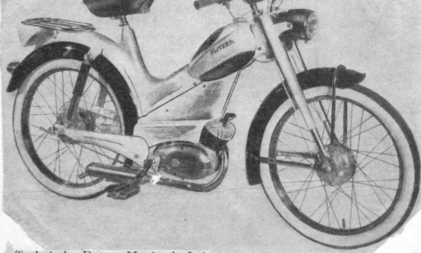
Technische Daten: Maximale Leistung ungedrosselt: 1.8 PS. Höchstgeschwindigkeit in Österreich, Vorschrift: 40 km/h. Kraftstoffverbrauch: 1.3 l/100 km, Gewicht: fahrbereit 49 kg. Zulässiges Gesamt-
